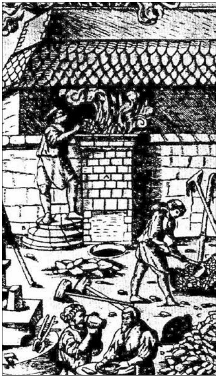
Dymarka wysoka, szybowa, tzw. „Stückofen” z połowy XVI wieku. Stosowano je na terenie Niemiec, Rosji i we Włoszech.
